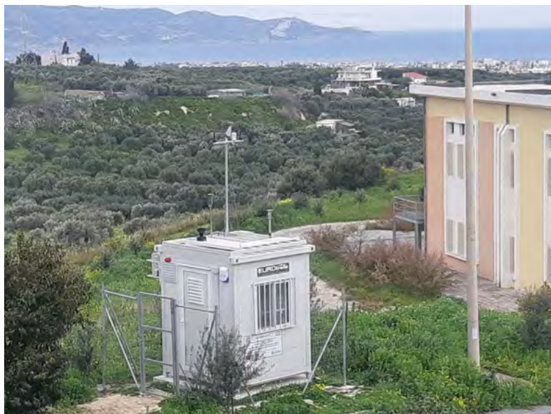
Ο Σταθμός στο Φινοκαλιά μετρά τα επίπεδα των θερμοκηπιακών αερίων από το 2002 με συνεχείς μετρήσεις από το 2014 και μετά.
