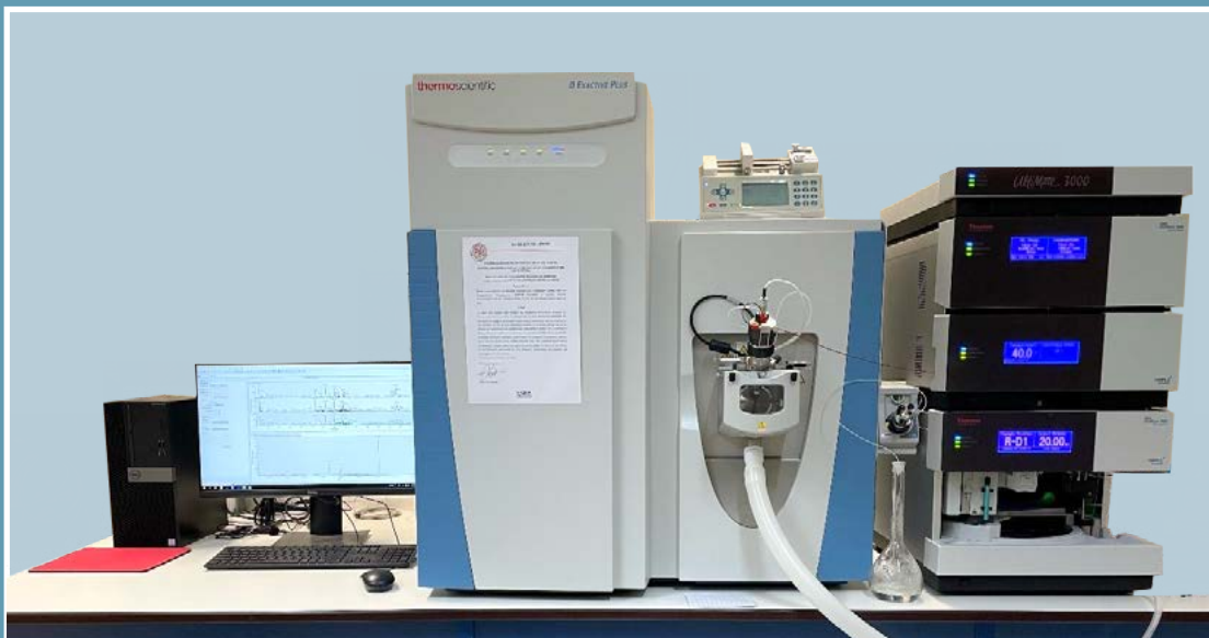
Φασματόμετρο μάζας Q-Exactive Plus της εταιρίας Thermo Scientific που στεγάζεται στα εργαστήρια φασματομετρίας μάζας του Τμήματος Χημείας του Πανεπιστημίου Κρήτης. (Φωτογραφία Κ. Μαρματάκης)
