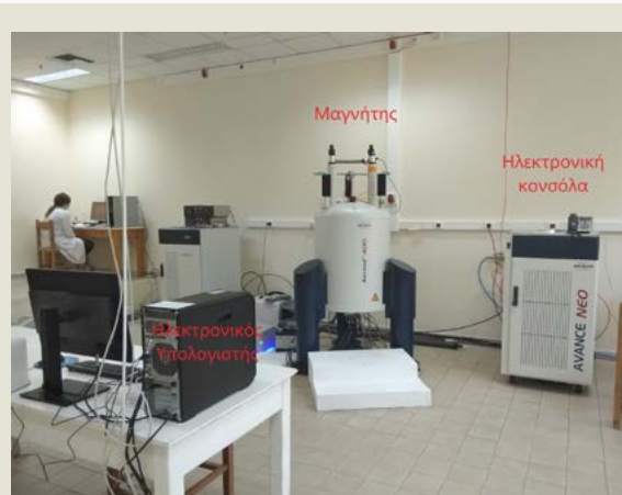
Το φασματόμετρο Bruker Avance Neo 400 MHz και τα κύρια μέρη που το απαρτίζουν.
